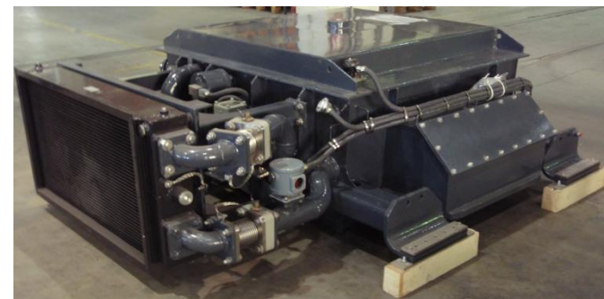
Primjer vučnog transformatora za Končar EMV
